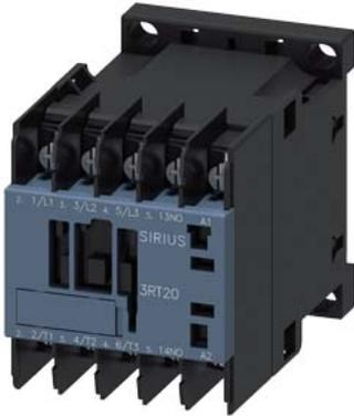
Leistungsschütz, AC-3 16 A, 7,5 kW / 400 V 1 S, AC 200 V, 50 Hz 200-220 V, 60 Hz, 3-polig Baugröße S00 Ringkabelschuhanschluss
