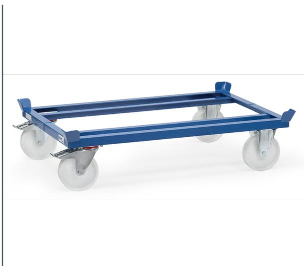
Construction en profilé d'acier mécano-soudé, revêtement époxy bleu RAL 5007, avec 4 inserts support de palettes. Pour palettes bois ou grillagées. 2 roues fixes et 2 roues pivotantes en polyamide, moyeu à roulement à rouleaux. Freins sur roues pivotantes conformément à la Norme EN 1757-3. Roulement aisé et non traçant mais bruyant. Roues résistantes aux agents corrosifs.
