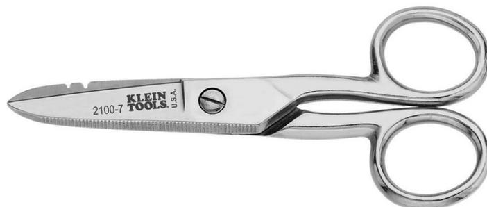
Diese Klein Tools Elektriker-Scheren mit Abisolierkerben sind für Anwendungen im Telekommunikations- und Elektrobereich entwickelt. Sie schneiden Draht, Kabel und Geflecht, unter anderem Kommunikationskabel der Stärken 19 AWG und 23 AWG. An der oberen Klinge befinden sich Kerben zum Abisolieren. Die gezahnte untere Klinge ermöglicht ein rutschesicheres Schneiden.
