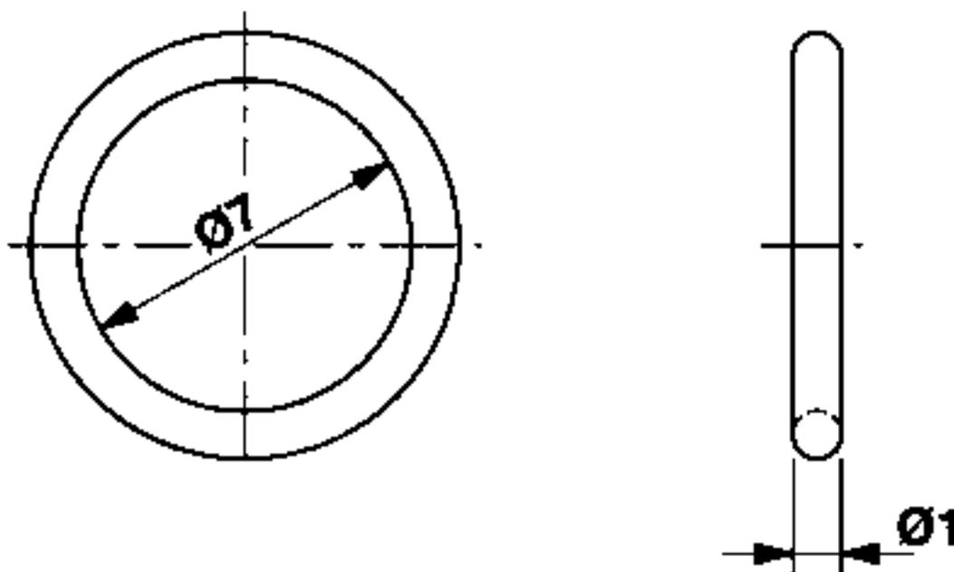
Optional mit O-Ring (grün) für Dichtheit im ungesteckten Zustand.
