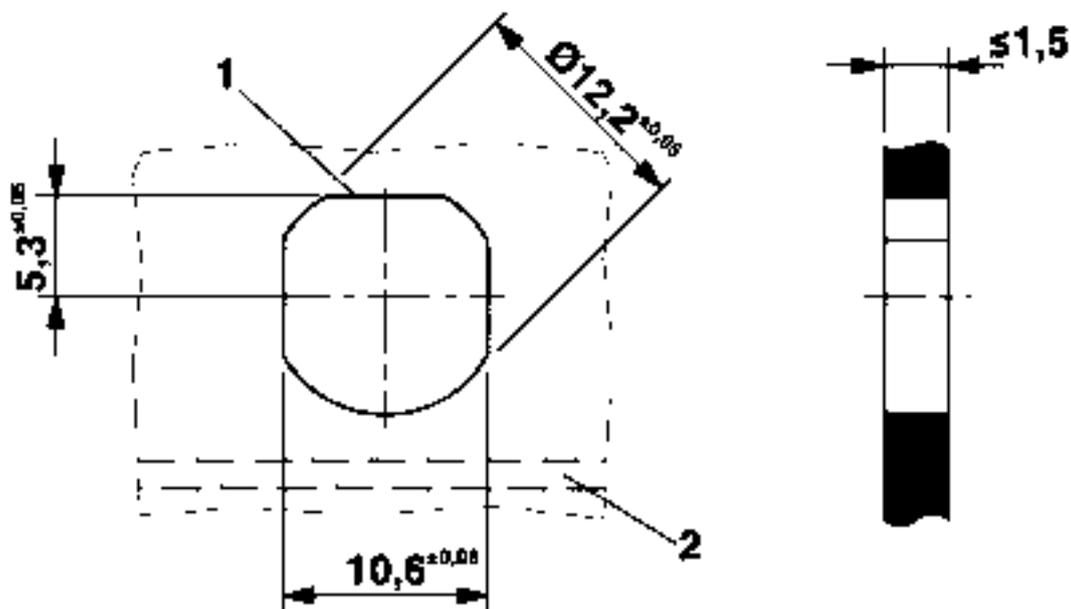
Gehäuseausschnitt für M12-Befestigungsgewinde, Montagewand mit Durchgangsbohrung (Alternativ mit Fläche als Verdreherschutz)
