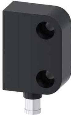
Magnetschalter Schaltelement, rechteckig klein 26 x 36 mm, für Türanschlag links, Schaltglieder: Sicherheitskontakte 1S+1Ö Meldekontakt 1Ö (31-32), mit 8 mm Rastanschluss Stecker 6-polig, ohne LED der dazu passende Schaltmagnet 3SE6714-3CA oder um 90° versetzt 3SE6724-3CA
