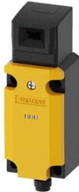
Sicherheits-Positionsschalter mit getrenntem Betätiger 5 Anfahrrichtungen Metallgehäuse, nach EN 50041 ASIsafe integriert AS-i Status: 1:F-IN1, 2:F-IN2 3:AS-i/FAULT Schleichschaltglieder 2Ö mit M12-Stecker 4-polig Kanal 1 an Ö, Kanal 2 an Ö
