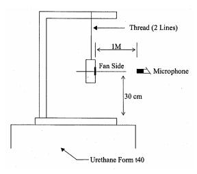
1 METER FROM MICROPHONE TO FAN INTAKE
