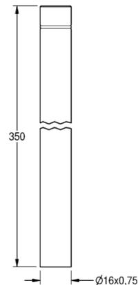
Spülrohrverlängerung mit O-Ring-Dichtung für Urinalspüler, Länge 350 mm, gerade, Messing poliert verchromt.
