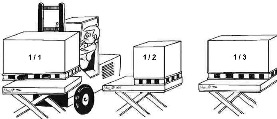
**Maximum zugelassene Horizontalkraft: 10% der Nennlast, auf der Plattformkante angebracht.**
