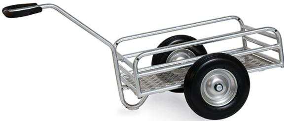
Handwagen für die Verwendung im Außenbereich. Aus Stahlrohr geschweißt, feuerverzinkt. Ladefläche aus Alu-Quintettblech. Geländer 180/250 mm hoch mit kräftigen Rohrverstreben. Anschraubbare Deichsel mit Sicherheitsgriff und hautsympathischem Softgrip-Bezug. Große Räder mit verzinkter Stahlblechfelge, mit pannensicherer Polyurethanbereifung, Naben mit Rollenlager. Verschraubte Radbefestigung für einfachen Radwechsel.
