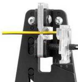
Kabel an Längenanschlag anlegen
