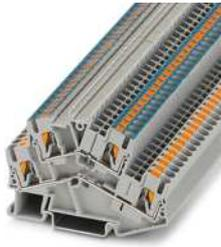
Doppelstockklemme, Nennspannung: 500 V, Nennstrom: 22 A, Anschlussart: Push-in-Anschluss, 1. und 2. Etage, Bemessungsquerschnitt: 2,5 mm<sup>2</sup>, Querschnitt: 0,14 mm<sup>2</sup> - 4 mm<sup>2</sup>, Montageart: NS 35/7,5, NS 35/15, Farbe: grau
