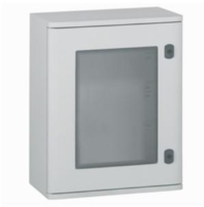
Legrand Wandschrank Marina mit Sichtfenster aus Sicherheitsglas, Schutzart IP 66 – IK 10, Klasse II, nach IEC/EN 60529, IEC/EN 62262, Außenabmessung 820 x 610 x 300 (Höhe x Breite x Tiefe in mm) Material: glasfaserverstärktes Polyester, Lichtgrau RAL 7035, selbstverlöschend 960 °C, besonders für korrosive Umgebung geeignet, Tür beidseitig anschlagbar, inkl. Doppelbarverschluss mit Doppelbartschlüssel.
