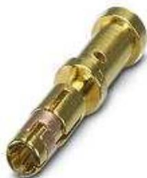
Crimpkontakt, gedreht, Kontaktdurchmesser: 1 mm, Crimpbereich: 0,06 mm<sup>2</sup> ... 0,25 mm<sup>2</sup>
