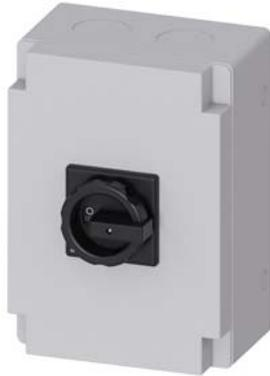
SENTRON, Lasttrennschalter 3LD, Hauptschalter, 3-polig, Iu: 100 A, Betriebsleistung / bei AC-23 A bei 400V: 37 kW, Isolierstoff-Kapselung für metrische Verschraubung, Drehantrieb, schwarz
