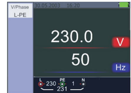
Figura 20 Schermata durante la misurazione della tensione e della frequenza
