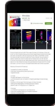
Mit IRmobile kann die Infrarot-Temperaturmessung direkt auf einem angeschlossenen Smartphone oder Tablet überwacht und analysiert werden. Diese App funktioniert auf den meisten Android-Geräten ab Version 5 mit einem Micro-USB oder USB-C-Anschluss, der USB-OTG (On The Go) unterstützt. Die App ist einfach zu bedienen: Nachdem die IR Kamera an den Micro-USB oder USB-C-Anschluss eines Smartphones oder Tablets angeschlossen wurde, startet die App automatisch. Die Kalibrierdateien werden
