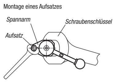
Wenn Sie einen Aufsatz auf den Spannarm montieren, sichern Sie den Spannarm mit einem Schraubenschlüssel, damit er keine Drehkraft aufnimmt.
