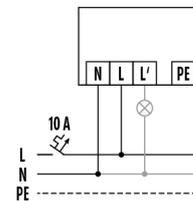
Standardbetrieb mit optionalem Anschluss von externen Lasten
