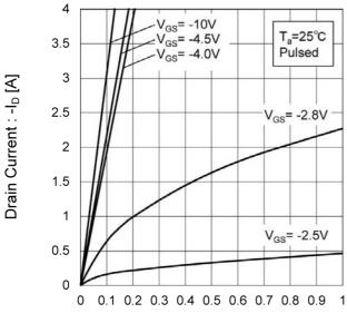
Drain - Source Voltage : -V<sub>DS</sub> [V]
