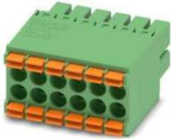
Steckerteil, Nennstrom: 8 A, Bemessungsspannung (III/2): 160 V, Polzahl: 6 mit 12 Kontakten, Rastermaß: 3,5 mm, Anschlussart: Federkraftanschluss, Farbe: grün, Kontaktoberfläche: Zinn
