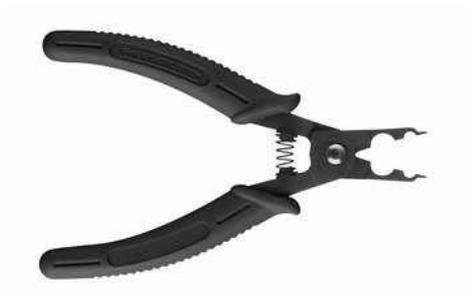
ERSA Spitzenwechselwerkzeug Dieses Werkzeug ermöglicht ein schnelles und sicheres Wechseln aller Ersa Lötspitzen sowie aller Entlöteinsätze der Typen 422. Zusätzlich ist ein Seitenschneider für Kupferdraht und ein Schraubendreher integriert, so daß mehrere Funktionen mit diesem universellen Werkzeug möglich sind. Ausführung: Schenkel mit Griffhüllen aus leitendem Material für ESD-sicheres Arbeiten mit Öffnungsfeder für ermüdungsarmes Handling.
