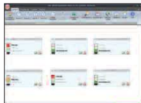
Modul 1: Zustandsanzeige der eingebundenen Signalsäulen
