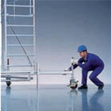
**Fahrbalken** mit und ohne Teleskopier-einrichtung (aus Stahl) dienen zur Basisverbreiterung und erhöhen die Standfestigkeit. Die Teleskopiereinrichtung vereinfacht das Verfahren ganzer Gerüste ohne aufwendigen Gerüstumbau. Wahlweises Aufstecken der Standleitern auf Rohrverbinder ermöglicht freizügiges Arbeiten an Decke oder Wand.
