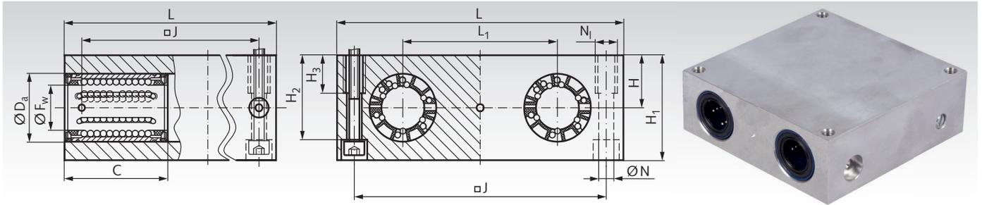
**Werkstoff:** Stranggepresstes Aluminiumgehäuse mit vier geschlossenen Linearlagern der ISO-Reihe 3 in Premium-Qualität. Mit selbsttätigem Fluchtungsfehler-Ausgleich (Winkelausgleich) und Doppellippendichtungen.
