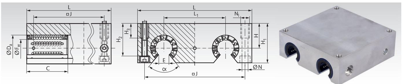
**Werkstoff:** Stranggepresstes Aluminiumgehäuse mit vier offenen Linearlagern der ISO-Reihe 3 in Premium-Qualität. Mit selbsttätigem Fluchtungsfehler-Ausgleich (Winkelausgleich) und Doppellippendichtungen.
