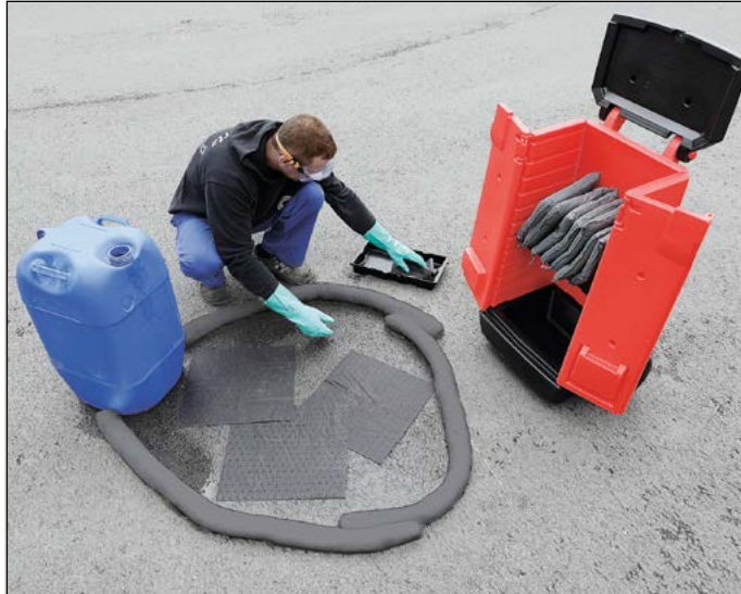
Die herausnehmbaren Auffangschalen des Transportwagens sind ideal zum Auffangen von herabtropfenden Flüssigkeiten bzw. zur vorübergehenden Sammlung der flüssigkeitsgetränkten Aufsaugtücher.
