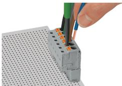
Leiter anschließen – Push-in CAGE CLAMP®-Anschluss-Drückerbetätigung zum Anschluss feindrätiger Leiter
