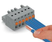
Leiter anschließen – direktes Stecken von eindrätigen Leitern oder feindrätigen Leitern mit Aderendhülse.
