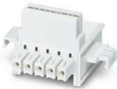
Tragschienen-Busverbinder, Farbe: grau, Nennstrom: 8 A (parallele Kontakte), Bemessungsspannung (III/2): 125 V, Polzahl: 5, Rastermaß: 3,81 mm, Montage: Tragschienenmontage, Verriegelung: ohne, Befestigungsart: ohne, Verpackungsart: verpackt im Karton, Artikel mit vergoldeten Kontakten, Busstecker zur Verbindung mit Elektronikgehäusen, 5 Parallelkontakte
