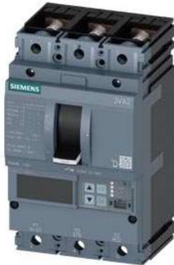
Leistungsschalter 3VA2 IEC Frame 160 Schaltvermögenklasse M Icu=55kA @ 415 V 3-polig, Motorschutz ETU550M, LSI, In=63A Überlastschutz Ir=25A ...63A Kurzschlusschutz ISD=1,2... 15x In,li=3...15x In Schraubenflächanschluss
