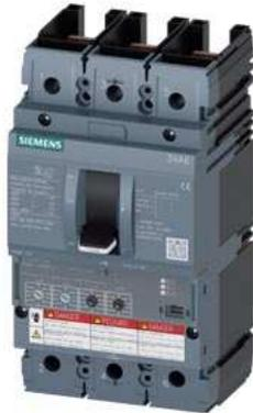
Leistungsschalter 3VA6 UL Frame 150 Schaltvermögenklasse M 35kA @ 480V 3-polig, Anlagenschutz ETU330, LIG, In=150A Überlastschutz, 100% rated Ir=60A...150A Kurzschlusschutz Ii=1,5...10 x In Erdschlusschutz Ig=0,2...1 x In, tg=0,1/0,3s ohne Anschluss
