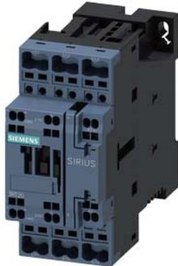
Leistungsschütz, AC-3 38 A, 18,5 kW / 400 V 1 S + 1 Ö AC (50 - 60 Hz) / DC AC / DC 21-28 V, 3-polig Baugröße S0, Federzuganschluss
