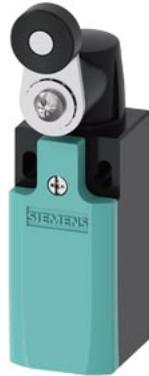
Positionsschalter Kunststoffgehäuse nach DIN EN 50047, 31 mm geeignet für -40 °C Geräteanschluss 1 x (M20 x 1,5) 1S/2Ö Sprungkontakte Schwenkhebel, 21 mm lang rechts/links einstellbar mit Kunststoffrolle 19 mm
