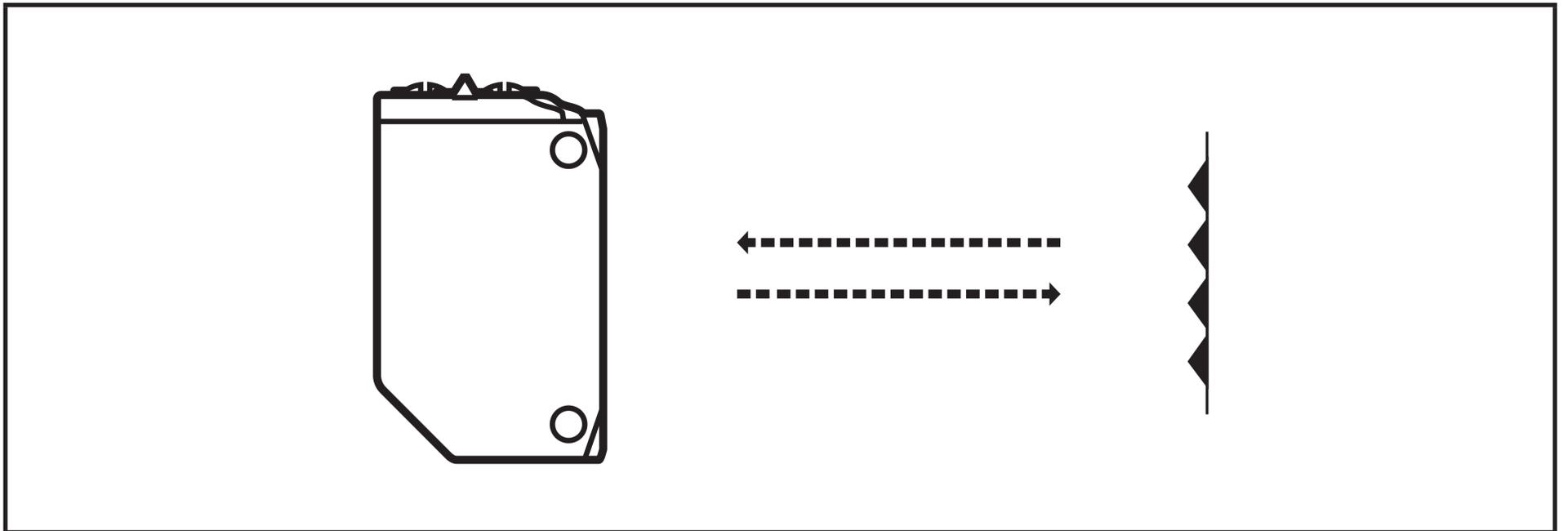
▶ Den Tripelspiegel oder die Reflexfolie hinter dem zu erfassenden Objekt anbringen.
