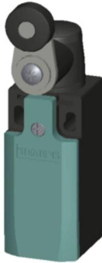
SIRIUS POSITIONSSCHALTER METALLGEHAEUSE NACH EN50047, 31MM GERAETEANSCHLUSS 1X(M20X1,5); 1S/1OE SCHLEICKONTAKTE SCHWENKHEBEL,21MM LANG, RECHTS/LINKS EINSTELLBAR MIT KUNSTSTOFFROLLE 19MM
