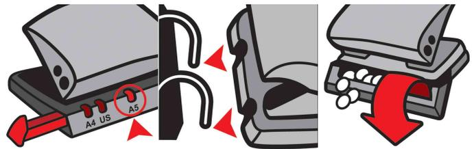
Anschlagsschiene - System zum Zentrieren - Entleerungsklappe
