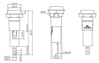
Dimensions : Millimetres Tolerances : ±0.3mm
