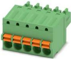
Leiterplattenstecker, Nennquerschnitt: 1,5 mm<sup>2</sup>, Farbe: grün, Nennstrom: 8 A, Bemessungsspannung (III/2): 160 V, Kontaktoberfläche: Zinn, Kontaktart: Buchse, Anzahl der Potenziale: 5, Anzahl der Reihen: 1, Polzahl: 5, Anzahl der Anschlüsse: 5, Artikelfamilie: FK-MCP 1,5/...-ST, Rastermaß: 3,5 mm, Anschlussart: Push-in-Federanschluss, Anschlussrichtung Leiter/Platine: 0 °, Stecksystem: COMBICON MC 1,5, Verriegelung: ohne, Befestigungsart: ohne, Verpackungsart: verpackt im Karton
