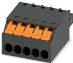
Leiterplattenstecker, Nennquerschnitt: 1,5 mm<sup>2</sup>, Farbe: schwarz, Nennstrom: 8 A, Bemessungsspannung (III/2): 160 V, Kontaktoberfläche: Zinn, Kontaktart: Buchse, Anzahl der Reihen: 1, Polzahl: 5, Artikelfamilie: XPC 1,5/..-ST, Rastermaß: 3,5 mm, Anschlussart: Push-X-Anschluss, Anschlussrichtung Leiter/Platine: 0 °, Rasthaken: - ohne Rasthaken, Stecksystem: COMBICON MC 1,5, Verriegelung: ohne, Befestigungsart: ohne, Verpackungsart: verpackt im Karton
