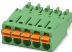
Leiterplattenstecker, Nennquerschnitt: 1,5 mm<sup>2</sup>, Farbe: grün, Nennstrom: 8 A, Bemessungsspannung (III/2): 160 V, Kontaktoberfläche: Zinn, Kontaktart: Buchse, Anzahl der Potenziale: 5, Anzahl der Reihen: 1, Polzahl: 5, Anzahl der Anschlüsse: 5, Artikelfamilie: FMC 1,5/...-ST, Rastermaß: 3,5 mm, Anschlussart: Push-in-Federanschluss, Anschlussrichtung Leiter/Platine: 0 °, Stecksystem: COMBICON MC 1,5, Verriegelung: ohne, Befestigungsart: ohne, Verpackungsart: verpackt im Karton
