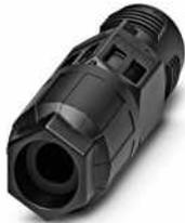
Leitungsverbinder, QUICKON-Anschluss, Polzahl: 3+PE, 0,5 mm<sup>2</sup> ... 1,5 mm<sup>2</sup>, 690 V, 17,5 A, schwarz, mit einer QUICKON-Mutter, Leitungsaußendurchmesser: 10 mm ... 13 mm, QUICKON-Schnellanschluss
