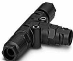
T-Verteiler, QUICKON-Anschluss, Polzahl: 3+PE, 0,5 mm<sup>2</sup> ... 1,5 mm<sup>2</sup>, 690 V, 17,5 A, schwarz, mit zwei QUICKON-Muttern, Leitungsaußendurchmesser: 10 mm ... 13 mm
