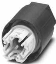
Mutter, QUICKON-Anschluss, Polzahl: 3+PE, 0,5 mm<sup>2</sup> ... 1,5 mm<sup>2</sup>, 690 V, 17,5 A, schwarz, Leitungsaußendurchmesser: 10 mm ... 13 mm
