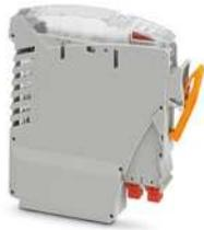
Relaismodul für VIP I/O-Marshalling-Basiselemente. Zum Schalten von 230-V-AC-Lasten bis max. 3 A. Integrierte Sicherung und Sicherungsausfallanzeige. Schließerkontakt nutzbar.
