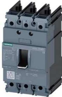
Leistungsschalter 3VA5 UL Frame 125 Schaltvermögenklasse S 25kA @ 480V 3-polig, Anlagenschutz TM210, FTFM, In=80A Überlastschutz Ir=80A fest eingestellt Kurzschlusschutz Ii=10 x In UL 489 SB (Naval), 50° C ohne Anschluss
