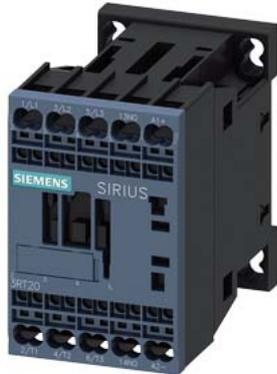
Leistungsschütz, AC-3 12 A, 5,5 kW / 400 V 1 S, DC 24 V 0,7-1,25\* US, mit Varistor integriert, 3-polig Baugröße S00, Federzuganschluss stehende Einbaulage
