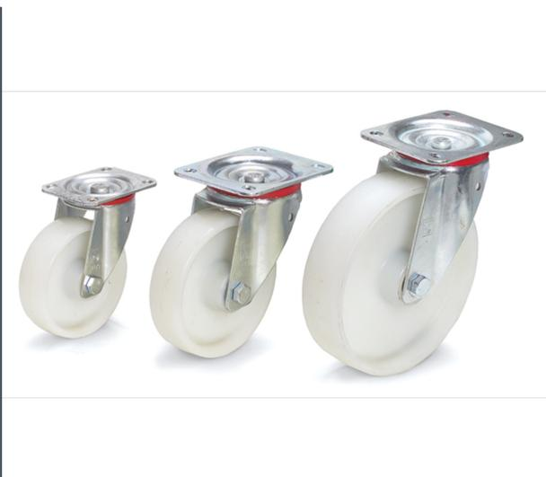
125 x 38 mm, roue en polyamide, moyeu à roulement à rouleaux. Armature en tôle d'acier galvanisée. Les roues résistent à l'eau salée et aux acides. Compatibles pour des températures de -40° à +90°C.
