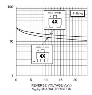
CAPACITANCE BETWEEN TERMINALS:C<sub>f</sub>(pF)
