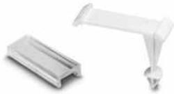
Phoenix-Modulbezeichnungsträger, zur Kennzeichnung von Modulen und Leiterplatten, für Bohrlochdurchmesser 3,9 bis 4,1 mm, Wand- bzw. Plattenstärke 1,5 - 2,0 mm, Beschriftung mit Einsteckstreifen ESL, EST oder ES/LP-BW-GB, Schriftfeldgröße: 29 x 8 mm
