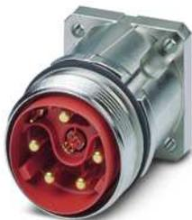
Gerätesteckverbinder, Vorderwand, SB, gerade, geschirmt: ja, für Standard- und SPEEDCON-Verriegelung, M40, Polzahl: 4+4+4+PE / 3+N+PE, Kontaktart: Stift, Crimpanschluss, O-Ring axial, 4x Ø4,2, Flanschmaß: 40 mm x 40 mm, Kodierung:CAT5, Kodierung 1
