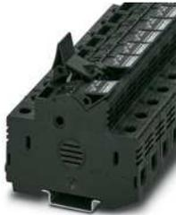
Sicherungsreihenklemme, Art der Sicherung: Glas / Keramik / ..., Sicherungstyp: Midget / 10,3 x 38, Nennspannung: 72 V, Nennstrom: 32 A, Anschlussart: Schraubanschluss, Bemessungsquerschnitt: 16 mm<sup>2</sup>, Querschnitt: 1,5 mm<sup>2</sup>- 25 mm<sup>2</sup>, Montageart: NS 35/7,5, NS 35/15, Farbe: schwarz
