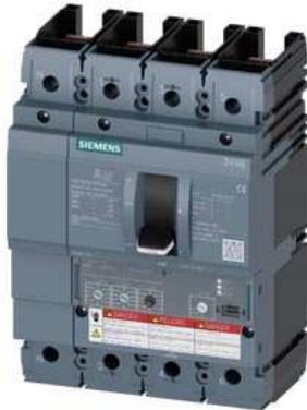
Leistungsschalter 3VA6 UL Frame 150 Schaltvermögenklasse C 100kA @ 480V 4-polig, Anlagenschutz ETU320, LI, In=40A Überlastschutz Ir=16A...40A Kurzschlusschutz Ii=1,5...12 x In N-Leiterschutz einstellbar (OFF, 100%) ohne Anschluss
