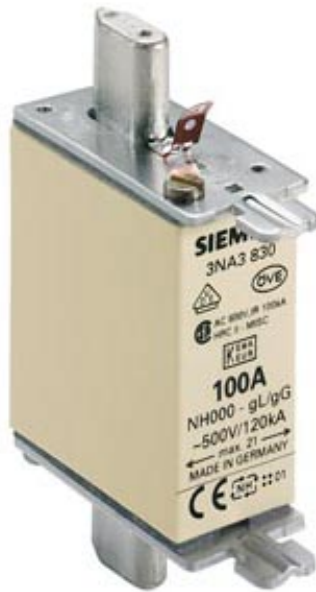
CARTOUCHE FUSIBLE NH GL/GG AVEC LANGUETTES D'ACCROCHAGE NON ISOLEES TAILLE 000,100A,AC 500V/DC 250V
