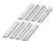
Nastro Zack piatto, Striscia, bianco, siglato, siglatura trasversale: numeri progressivi 1-10, 11-20 ecc. fino a 91-100, Tipo di montaggio: Inserimento a scatto in scanalatura piatta portacartellini, per morsetti con spessore: 5 mm, Dimensioni campo di siglatura: 5,15 x 5,15 mm
