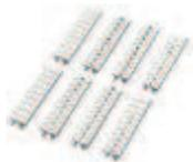
Nastro Zack, Striscia, bianco, siglato, siglabile con: Plotter, siglatura trasversale: numeri progressivi 1-10, 11-20 ecc. fino a 491-500, Tipo di montaggio: Inserimento a scatto in scanalatura alta portacartellini, per morsetti con spessore: 5,2 mm, Dimensioni campo di siglatura: 5,15 x 10,5 mm
