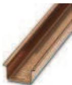
Guida di supporto, materiale: Rame, non perforato, spessore 1,5 mm, altezza 15 mm, larghezza 35 mm, lunghezza: 2 m
