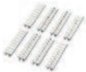
Nastro Zack, Striscia, bianco, siglato, siglatura longitudinale: numeri progressivi 1-10, 11-20 ecc. fino a 491-500, Tipo di montaggio: Inserimento a scatto in scanalatura alta portacartellini, per morsetti con spessore: 5,2 mm, Dimensioni campo di siglatura: 5,15 x 10,5 mm
