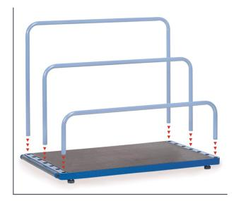
Profilstahl und Stahlrohr geschweißt, pulverbeschichtet, Holzplattform. 7 Verstellmöglichkeiten für Einsteckbügel. Bügelabstand licht 90 mm, 4 Gummifüße. An einer Stirnseite eine sechsteilige Anlaufrolle. Lieferung ohne Bügel.
